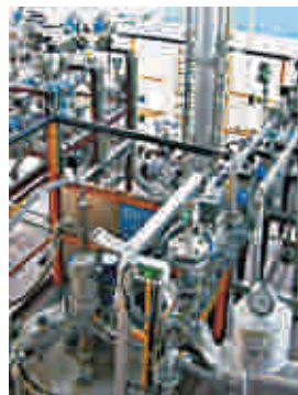
连接各种燃烧喷嘴的安全及控制阀组件
