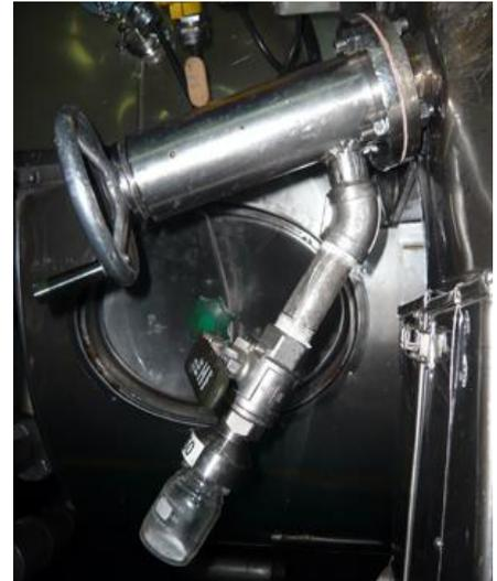
配置了隔膜泵，PTFE 衬里管和 PTFE 软管，可用于酸性环境中的模块化取样系统。可实现反应釜内产品循环取样，并可在取样循环中配备 PH 仪和电导率测量仪。整个系统可方便的在线清洗（由拉斯卡工程设计、制造、安装、调试、验证和维护）
